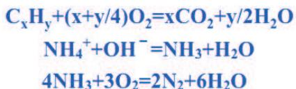
湿式催化氧化技术 ( Catalytic Wet Air Oxidation,简称CWAO)是在合适的催化剂作用下，高温 ( 150-300°C ) 高压 ( 1.5Mpa-10Mpa ) 条件下，以氧气或空气中的氧为氧化剂，在液相中将有机污染物氧化为无机物或小分子的化学过程。利用高压反应设备实现湿式催化氧化技术是我公司在环保领域的一个创新点。我司的混合器/反应器具有高速混合，高效传热，反应物停留时间的窄分布，重复性好，从而达到的高反应效率，高安全性能优势，能有效提升催化反应效率。
